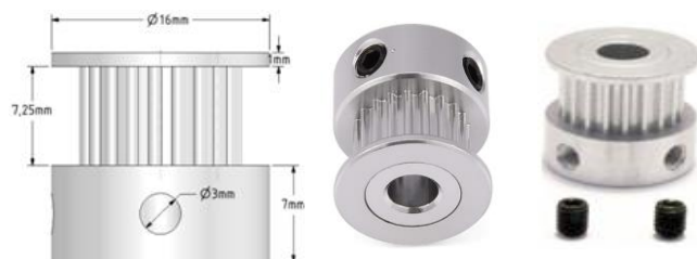
Figure 13 : Caractéristiques poulie crantée GT2
