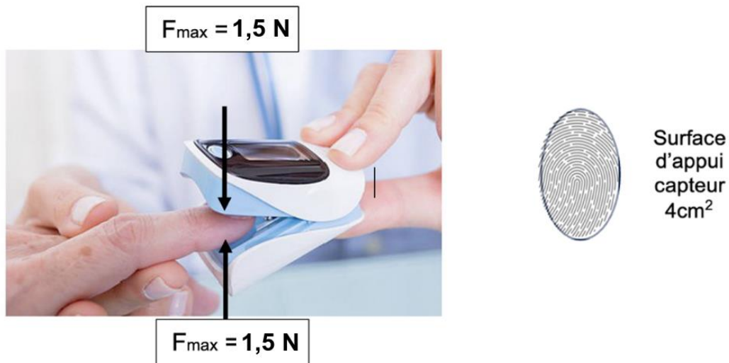
Figure 3 : représentation des forces exercées sur le doigt et de la surface d'appui du doigt sur le capteur
