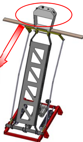
Constitution du contacteur et du portique de rechargement
